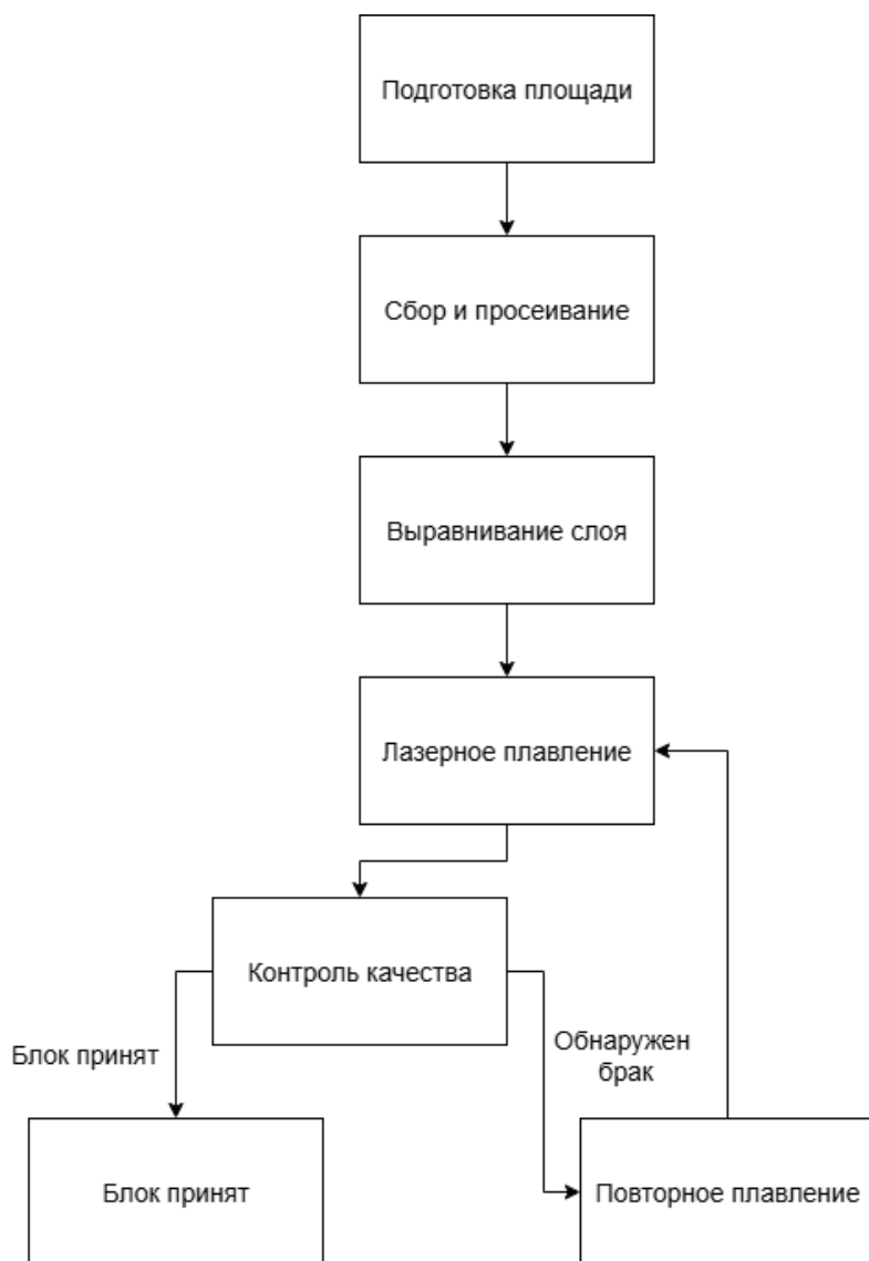
Рис. 3. Поточная линия лазерного спекания лунного грунта
