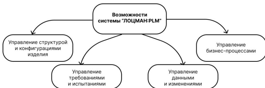
Рис. 1. Возможности системы Лощман:PLM, применимые для создания имитационной модели горнообогатительного процесса
